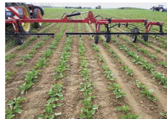
Im REB-Programm M2 ist Bandspritzen ab der Saat erlaubt. Hacken zwischen den Reihen.
