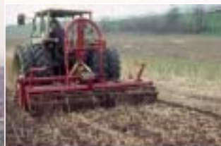
L'incorporation superficielle des résidus végétaux, avec un outil animé, avant le semis, aère le sol, accélère le réchauffement ainsi que la levée. La terre fine assure le plombage des graines.
