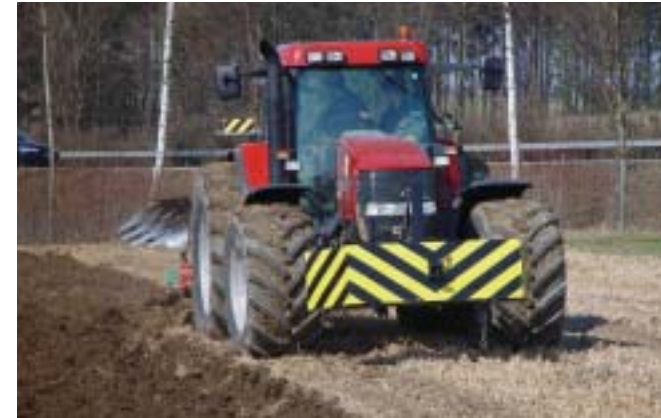
Le labour „onland“ diminue les risques de tassement et de lissage du sol
