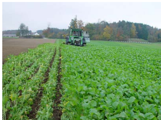
Strip-Till-Einsatz im Spätherbst. Im nächsten Frühjahr erfolgt die Rübensaat direkt in die bearbeiteten Streifen.
