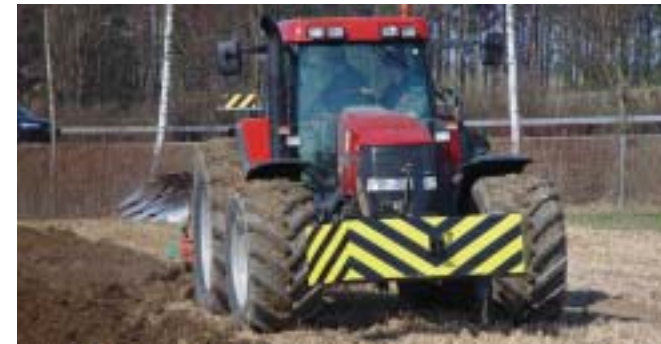
Das On-Land Pflügen minimiert, zusammen mit der entsprechenden Bereifung, die Risiken von Pflugsohlen und Unterbodenverdichtungen.
